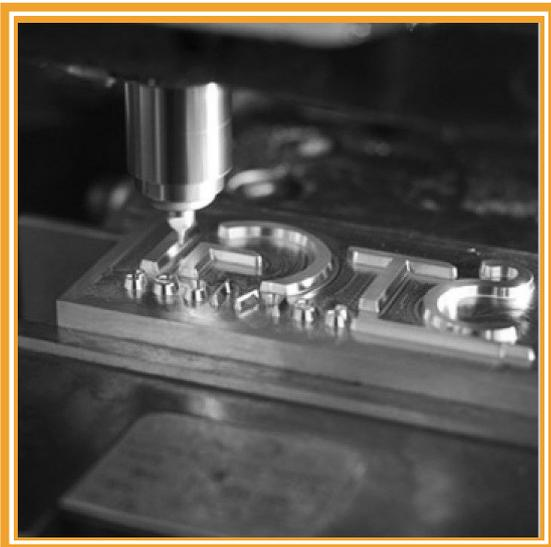
***Gravure : la gravure dite mécanique permet de réaliser des gravures profondes sur tout type de métaux (acier, laiton, cuivre, alu) et de plastiques (PEEK, PEHD).***
